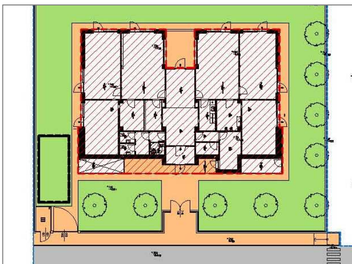
Fig. 6 - Posizione della vasca di laminazione prevista
